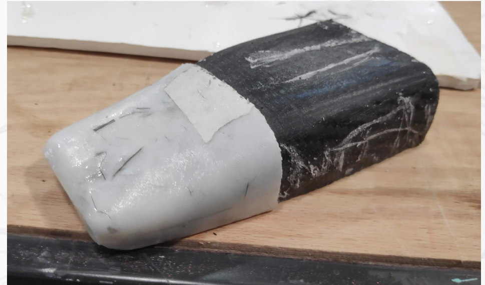
La carrocería esta creada de fibra de carbono con los moldes siendo impresos en 3D.
