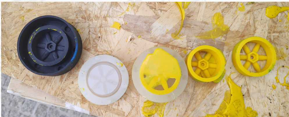
Las llantas están creadas con resina en moldes de silicona.
